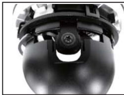
A. Remove the Dome Liner
